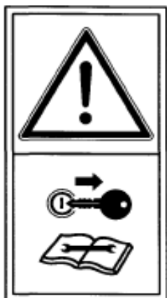
Рисунок 7.6 – Перед техобслуживанием и ремонтом выключите двигатель комбайна и извлеките стартовый ключ.
