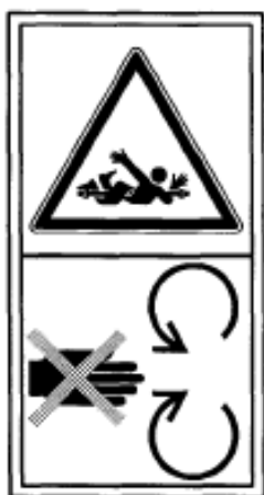
Рисунок 7.11 – Не допускайте соприкосновения любой части тела или одежды с карданными валами во время работы приспособления
