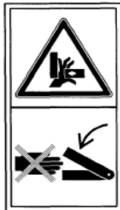
Рисунок 7.8 – Не открывайте и не снимайте защитные ограждения при включенном двигателе комбайна. Не допускайте соприкосновения любой части тела или одежды с движущимися частями приспособления.
