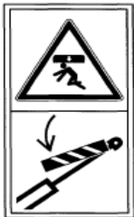
Рисунок 7.5 – Перед входом в опасную зону следует обеспечить безопасность путем блокировки гидроцилиндра подъема наклонной камеры комбайна.
