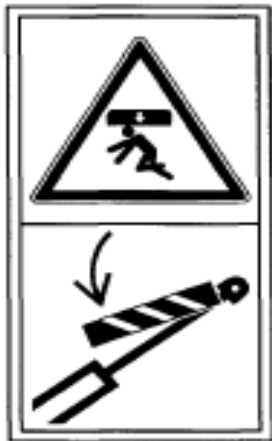
Рисунок 7.3 – Перед входом в опасную зону следует обеспечить безопасность путем блокировки гидроцилиндра подъема наклонной камеры комбайна.
