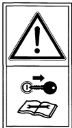
Рисунок 7.5 – Перед техобслуживанием и ремонтом выключите двигатель комбайна и извлеките стартовый ключ.
